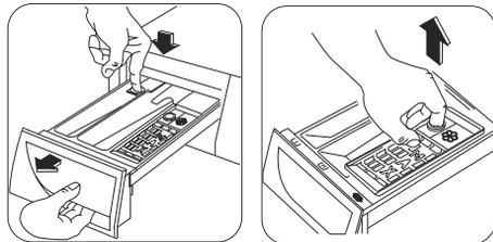
Aby čištění bylo snazší, lze vrchní díl komor na přísady vyjmout.
