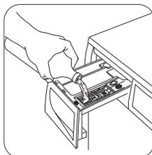
Vytáhněte zásuvku dávkovače až na doraz. Odměřte požadované množství pracího prostředku, nalijte ho do komory pro hlavní praní **[1]** a pokud si přejete provést program s fází předpírky nebo namáčení, nalijte ho do komory označené **[2]**.
