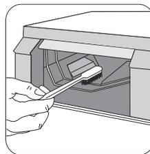
Po vyjmutí zásuvky použijte malý kartáček na čištění komor tak, aby všechny usazeniny pracího prášku byly odstraněny z vrchních i spodních částí výklenku.
