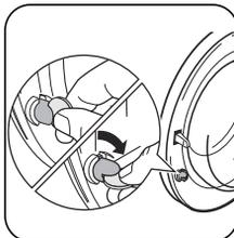
K **uvedení** tohoto zařízení do činnosti pootočte tlačítkem (bez stisknutí) uvnitř dvířek doprava, až zárez vodorovně. Můžete použít i minci.
