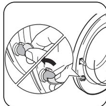
K **vypnutí** tohoto zařízení pootočte tlačítkem doleva, až je zárez svisle; nyní se dvířka dají opět zavřít.
