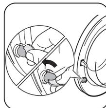
Для **отключения** этого устройства, чтобы снова можно было закрыть дверцу, поверните кнопку против часовой стрелки так, чтобы паз оказался в вертикальном положении.
